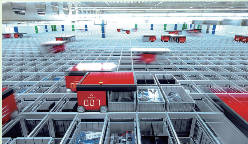
コンテナと自走ロボットを組み合わせた「立体自動倉庫」。ピッキングを自動で行う
